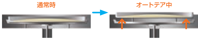
30秒に1度、試料皿が持ち上がり、誤差がリセットされます。
