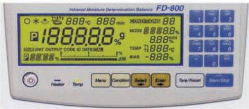
● FD-800搭載大型背光LCD數值顯示幕，測定條件及測定資訊清楚明瞭
